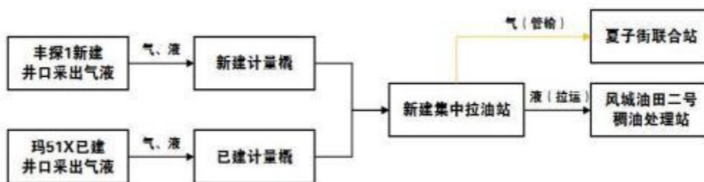
图 3.3-7 本工程布站工艺流程
