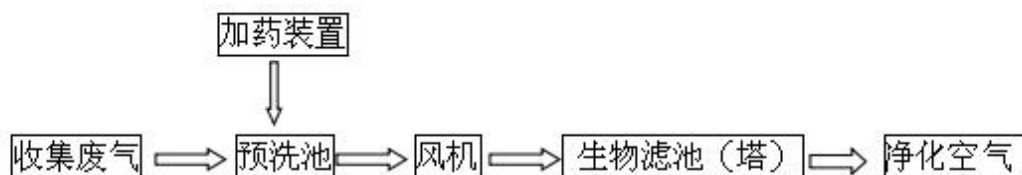
图 7.2-2 生物氧化除臭法工艺流程图
