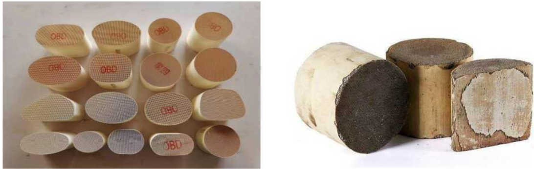
图3. 1-3 废汽车尾气三元催化剂（载体）
