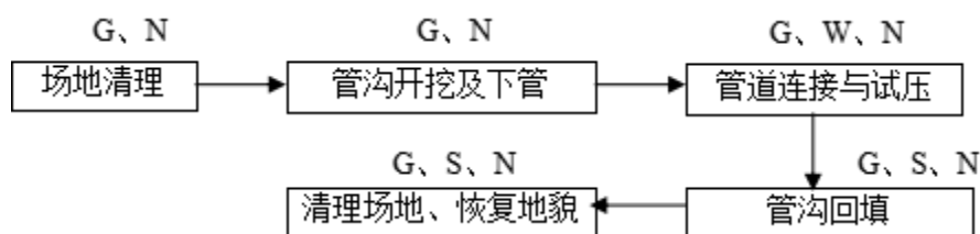
图 3.2-4 管道施工流程及排污节点图
