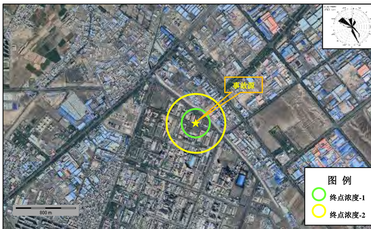
图 7.6-4 氢溴酸储罐泄漏事故预测后果范围图（最常见气象条件）
