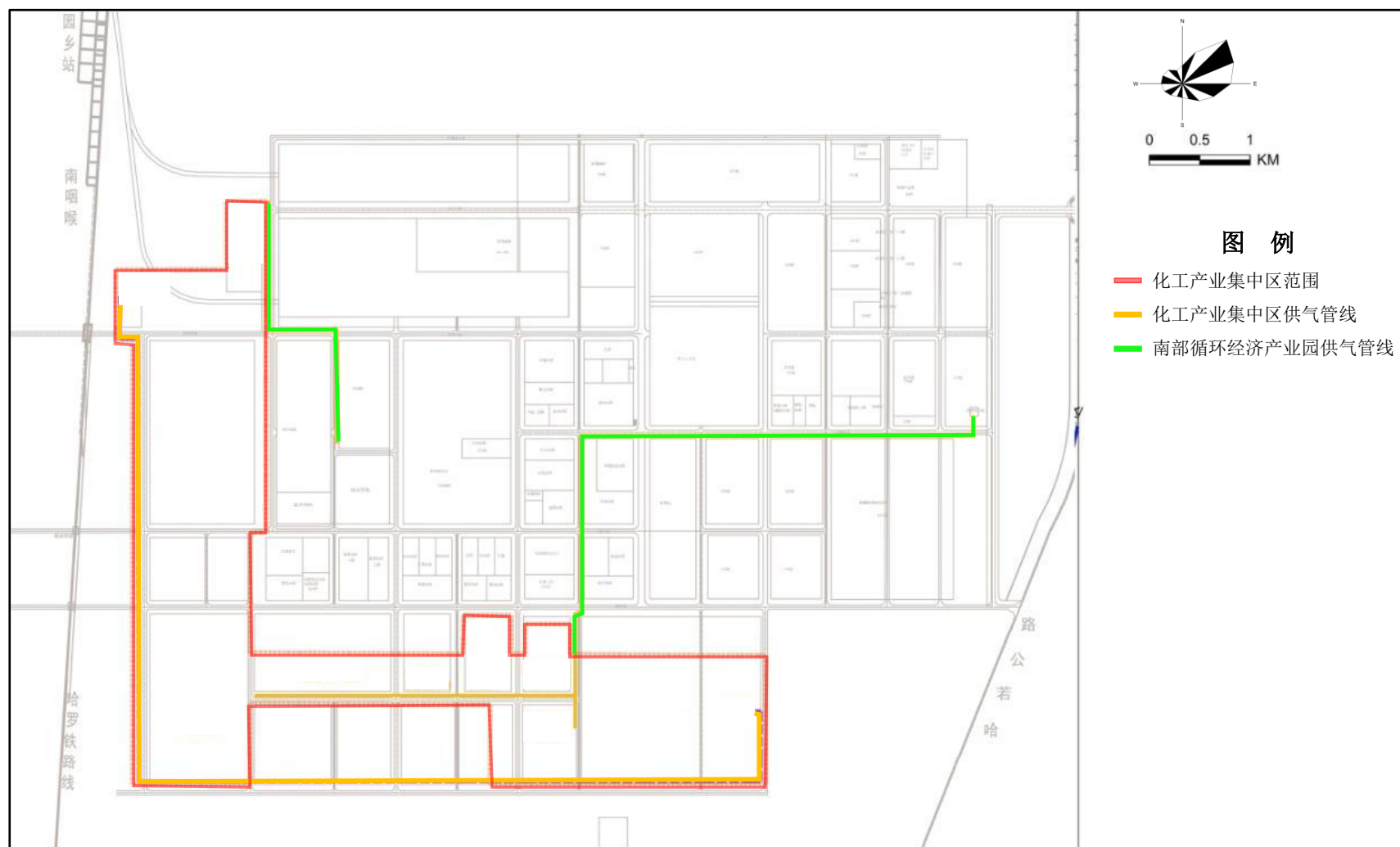
图 3.1.5-7 化工产业集中区供气管网分布图
