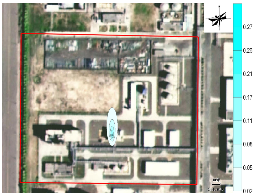
图 6.4.2-4 污水缓冲池泄漏 1000 天预测结果图
