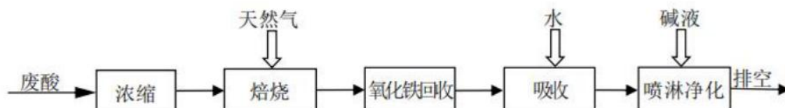
图 3.1-7 酸再生工艺流程图
