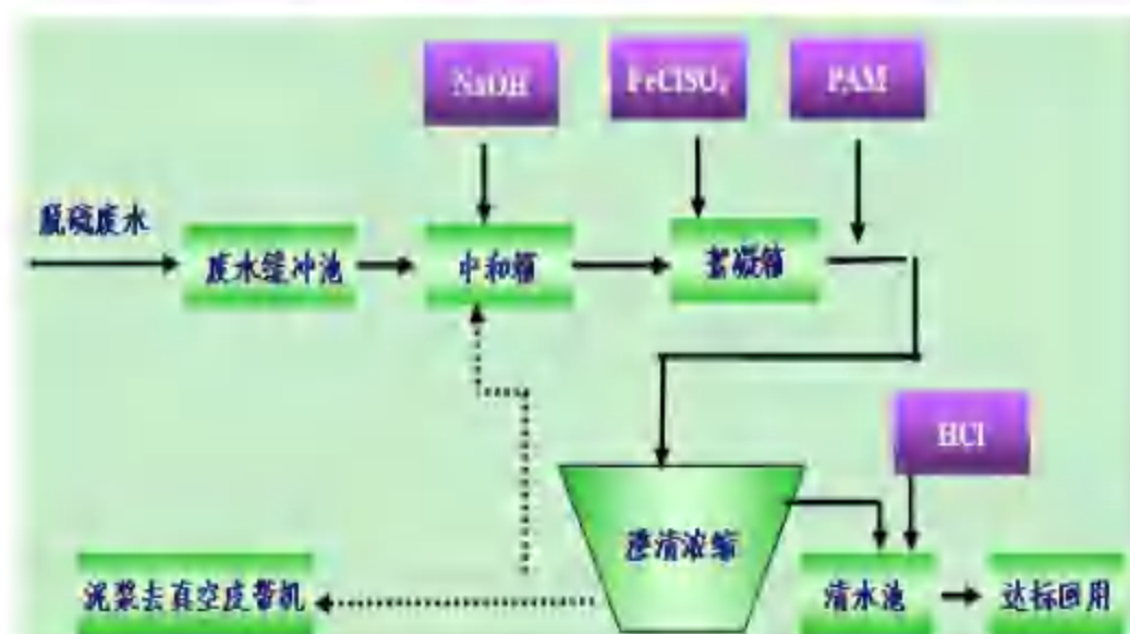
图 6.3-1 现有脱硫废水处理站工艺流程图
