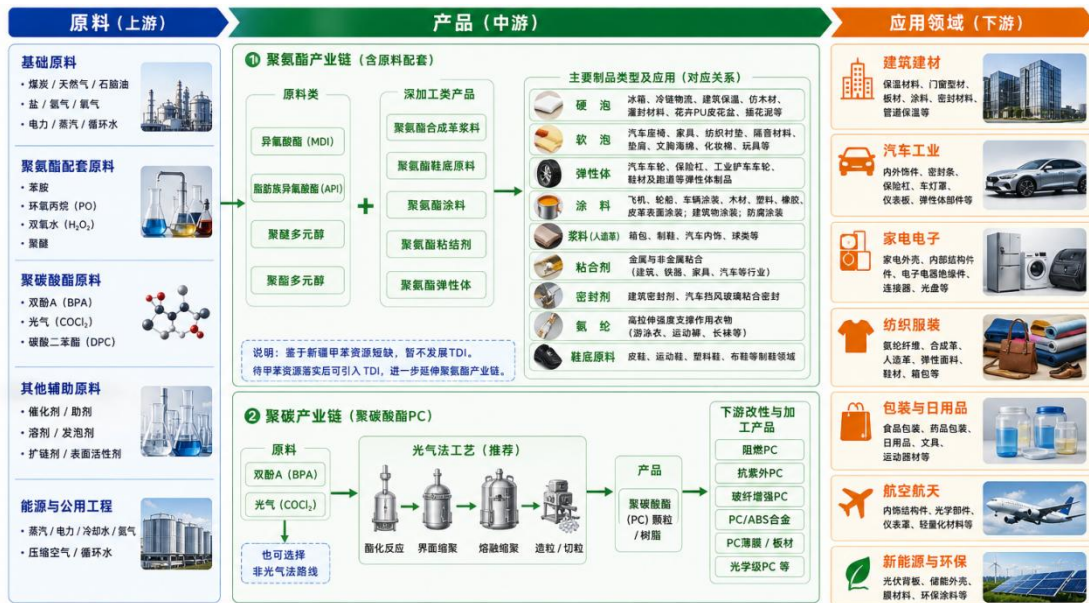
图 2.3.6-3 化工新材料产业链流程图
