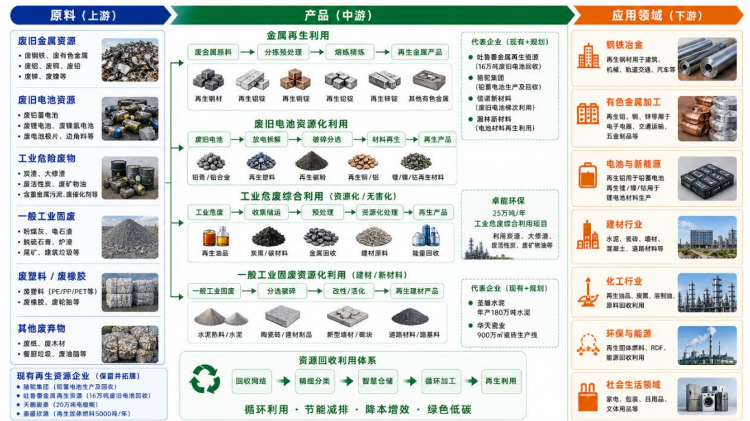
图 2.3.6-5 再生资源循环利用产业链流程图
